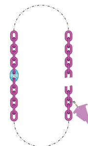
Abb. 14: Kranzkettenmontage mit Dominator
