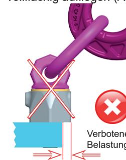
Abb. 3: VWBG-V muss vollflächig aufliegen (Auflage  $\geq D$ )
