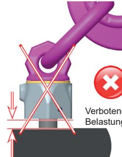
Abb. 2: Der Anschlagpunkt muss vollständig eingeschraubt sein.
