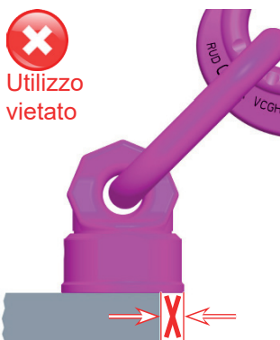
Fig. 3: Il diametro della superficie della controfaccia del carico deve essere \geq D
