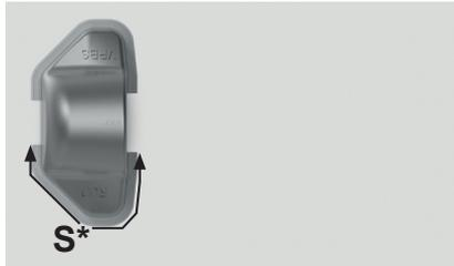
Fig. 1: Saldare sul blocchetto di saldatura 1
