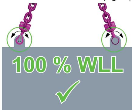
Fig. 10: WLL ammissibile sull'asse longitudinale
