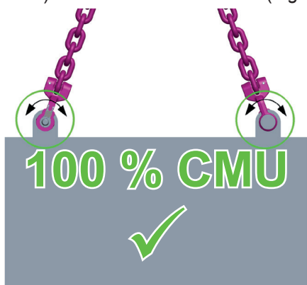
Fig. 10: Chargement admissible dans l'axe longitudinal
