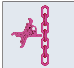
Contrôler Allongement du pas par une usure de l'épaisseur nominale
