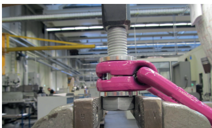
Fig. 5 : Placement du L-VLBG pour le démontage de la vis
