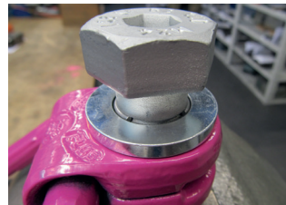
Fig. 7 : Bague d'écartement enfoncée dans le chanfrein
