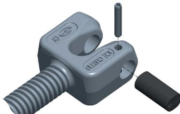
Fig. 2: Montage de la goupille et l'axe ovale
