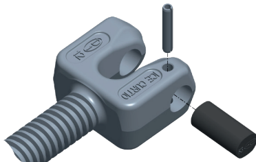
Fig. 2: Montage de la goupille et l'axe ovale
