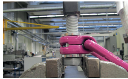
Abb. 8: Auflage des VLBG zur Demontage der Schraube
