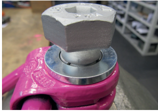
Abb. 10: Sprengring umlaufend vertieft in der Ansenkung positioniert
