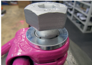
Image 9: Bague de retenue enfoncée sur tout le pourtour du chanfrein
