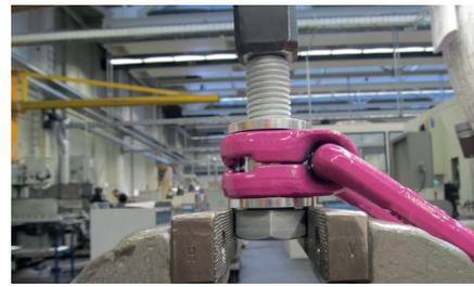
Image 7: Support du VLBG pour le démontage de la vis
