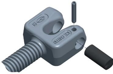
Fig. 2: Montaggio del perno di connessione e della coppiglia
