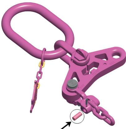
Fig. 14: Montage de l'axe de connexion VIP-G
