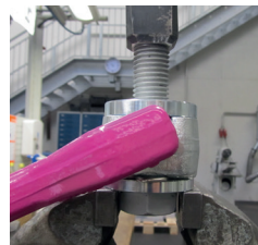
Rys. 12: Położenie ACP w celu demontażu śruby
