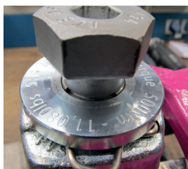
Rys. 14: Ring zabezpieczający umiejscowiony okrężnie w tuleji
