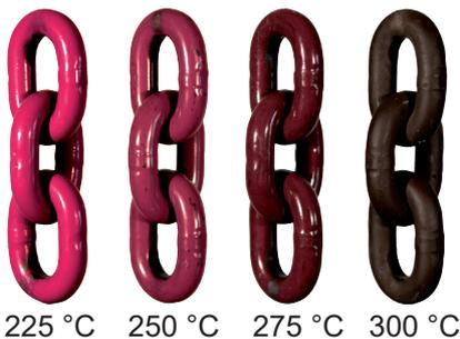
Fig. 8: Indicatore di surriscaldamento ICE brevettato per catene verniciate a polvere rosa
