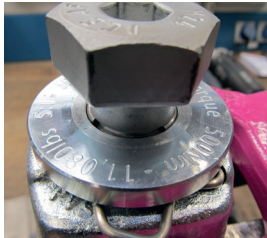
Fig. 14: Anillo de ajuste posicionado de manera profunda alrededor del avellanado
