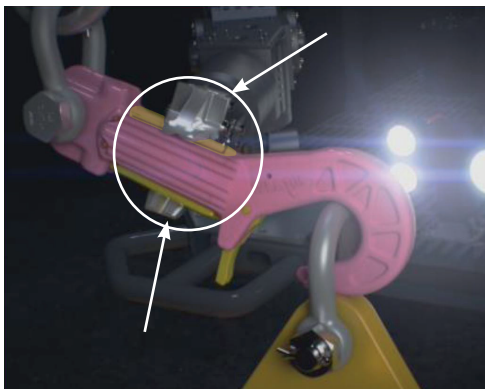
Abb. 5: Drücken der Entriegelungs- und Sperrklappe
