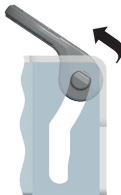
Рис. 16: Повернуть крепежную петлю OPTILASH в рабочее положение
