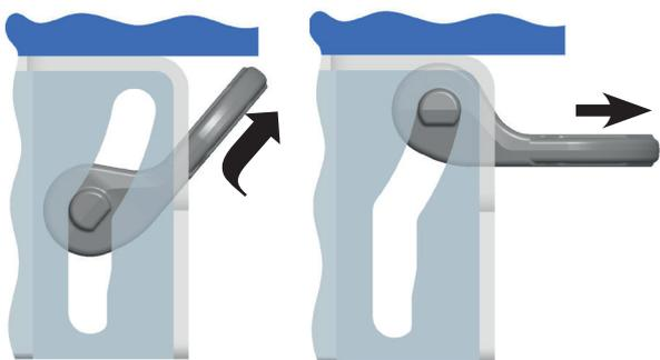
Рис. 15: Вытянуть крепежную петлю OPTILASH из кулисной коробки
