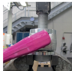
Fig. 12: Posizione dell'ACP per lo smontaggio del bullone
