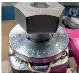
Fig. 14: Anello di fermo è posizionato tutt'intorno al foro d'entrata della boccola
