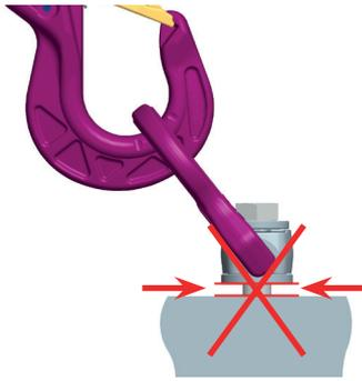
Рис. 8: Болт такелажной точки должен быть закручен полностью
