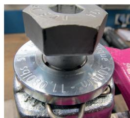
Рис. 14: Стопорное кольцо, установленное и заглубленное по всему периметру в раззенковку.
