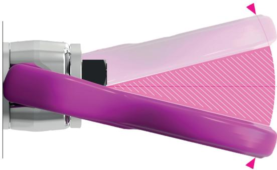
Fig. 10 : Le ressort empêche l'anneau de se retrouver dans la position hachurée
