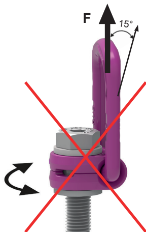
Fig. 7: movimiento de giro prohibido con carga en sentido del eje
