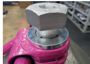
Fig. 10: anillo retenedor colocado en la hendidura
