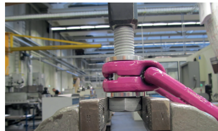
Fig. 8: base del VLBG-PLUS para desmontar el tornillo
