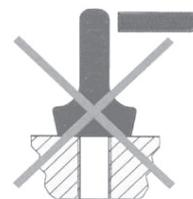
8. Quando è saldamente avvitato, il corpo anello del golfare femmina STARPOINT deve permettere una rotazione di 360°. Prima di agganciare gli elementi di sollevamento disporre in direzione di trazione.
