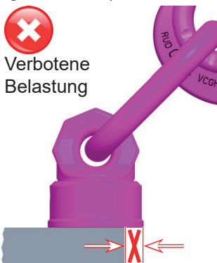
Abb. 3: VWBG muss vollflächig aufliegen (Auflage \geq D )
