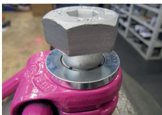
Fig. 9: Anello d'arresto correttamente pre-posizionato nello smusso della bussola.
