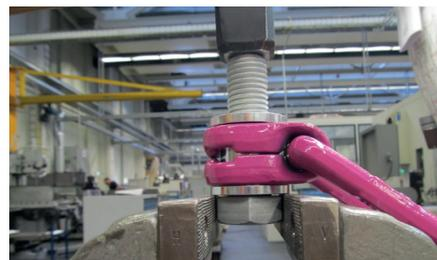
Fig. 7: Posizione di smontaggio del VLBG-PLUS
