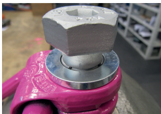
Рис. 10: стопорное кольцо по окружности утоплено в фаску
