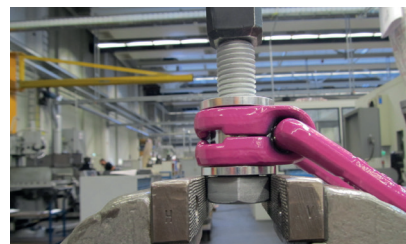
Рис. 8: Позиционирование VLBG-PLUS для демонтажа болта
