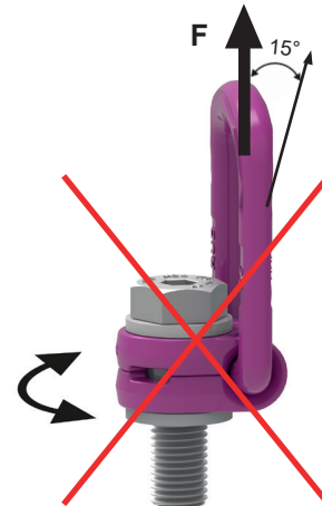
Рис. 7: Запрещенное вращение при нагрузке по направлению оси болта
