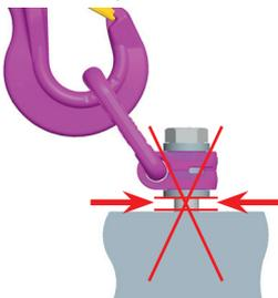
Abb. 4: Der Anschlagpunkt muss vollständig eingeschraubt sein.
