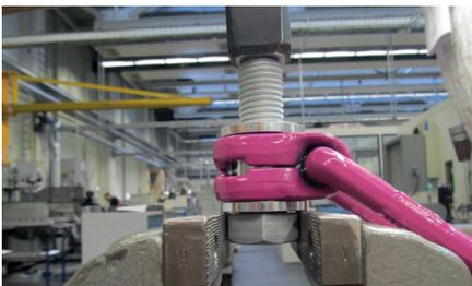
Abb. 7: Auflage des VLBG zur Demontage der Schraube
