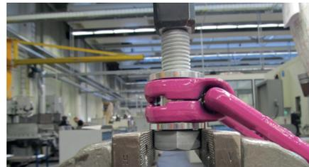
Image 7: Support du VLBG-PLUS pour le démontage de la vis
