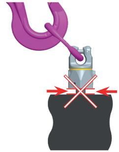
Abb. 3: So-PP muss vollständig eingeschraubt sein
