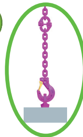
Ilustración 1: Montaje y uso correcto
