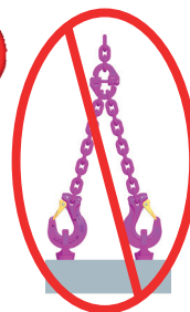
Ilustración 2: Montaje y uso incorrecto Solo se permite 1 ramal con carga
