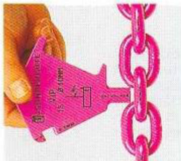
Verifica allungamento passo dovuto a usura dello spessore nominale
