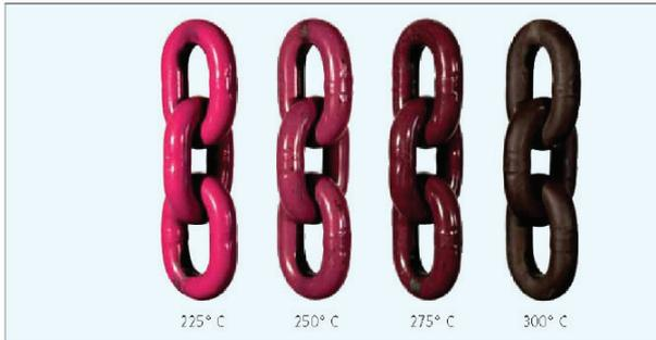
Специальное порошковое покрытие ICE указывает на температуру, при которой использовалась цепь ICE. При запрещенной эксплуатации при температуре свыше 300 °C покрытие приобретёт черно-коричневый цвет. В данном случае цепь ICE необходимо заменить или отправить производителю для проведения ремонта.
