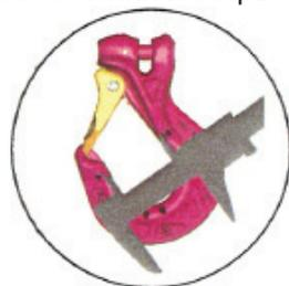
ф) Увеличение зева крюка не должно превышать 10 % от его номинальной величины, см. размер Fmax на крюке. Предохранительный замок должен защелкиваться на кончике крюка и замыкать его. Тщательно проверьте основание крюка на наличие зазубрин.
