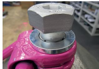
Abb. 8: Sprengling umlaufend vertieft in der Ansenkung positioniert
