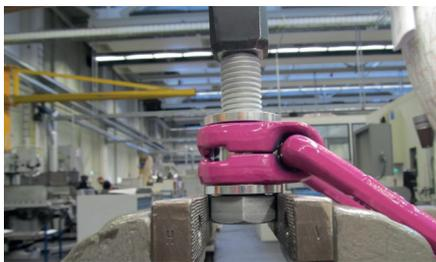
Abb. 6: Auflage des ICE-LBG-SR zur Demontage der Schraube
