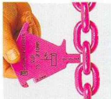
Contrôle de l'augmentation du pas de part l'usure du Ø intérieur du fil.
