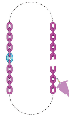
Fig. 14: Catena ad anello chiuso con Dominator
