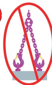
Fig. 2: Assemblaggio ed uso vietato. E' consentito l'uso con un solo braccio portante.
