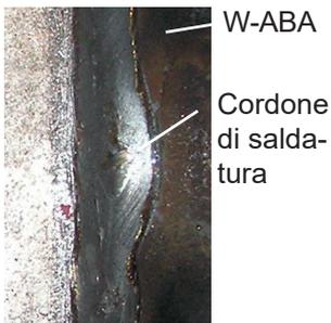
Fig. 1: Cordone di saldatura
