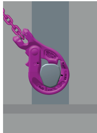
Abb. 6: Bauteil in Muldenzapfen eingehängt und verriegelt
