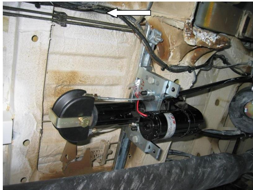
***Deutsch*****Montage des Linearantriebes**
